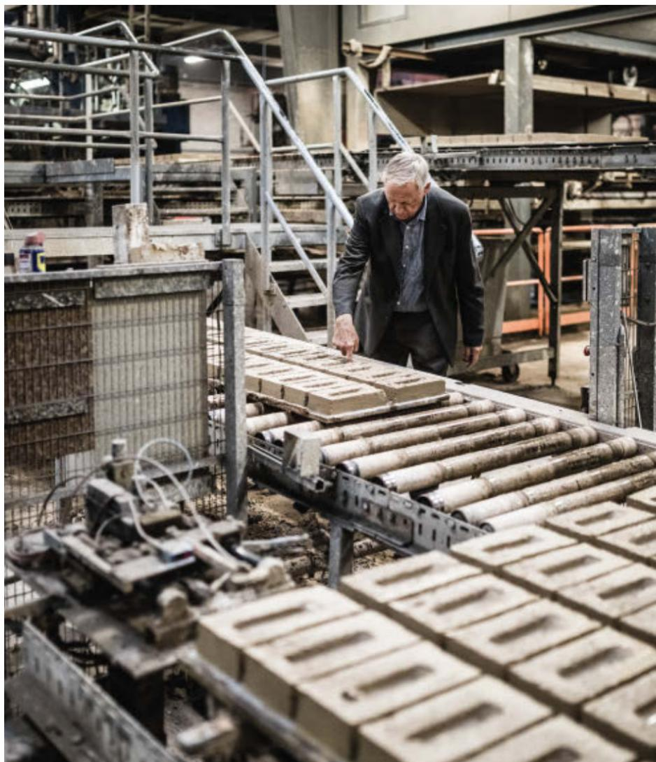
Bei Petersen Tegl wird der Lehm mittels Verfahrensweisen geknetet, geformt und gepresst, die bereits Anwendung fanden, als Ziegel noch von Hand hergestellt wurden. Durch diese Methode erhält der Lehm eine optimale Textur mit Kapillaren und Luftporen, die eine Ausweitung des Wassers bei Frost ermöglichen, ohne dass der Stein dabei beschädigt wird. Daher stellt die Tatsache, dass der Stein Wasser aufnehmen kann, kein Risiko für Frostschäden dar.
