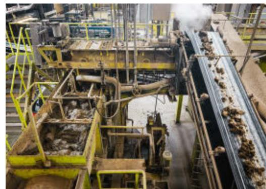
Die D-Steine werden mit Maschinen hergestellt, die in der Ziegelei dazu entwickelt wurden, die Herstellung von handgefertigten Ziegeln zu imitieren. Dabei wird das Aussehen des Steins nicht künstlich herbeigeführt, sondern ist eine natürliche Folge des Herstellungsverfahrens.
