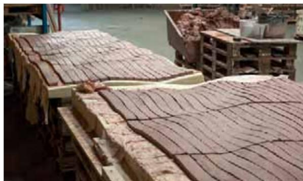
8. Alle Tonteile werden zum Trocknen in den Polyurethan-Formen platziert.
