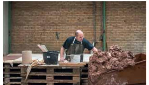
6. Der durchgeknetete Ton kann geformt werden.
