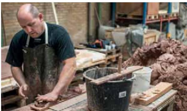
7. Der Ton wird in Holzformen gepresst.
