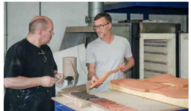
3. Vergleich der Krümmung der gebrannten Probeziegel mit der Gussform.
