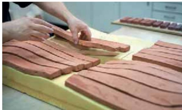
2. Kritische Prüfung der ersten Probeziegel nach dem Brand.
