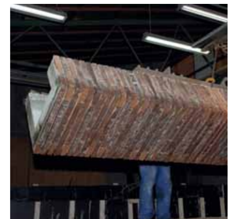
Die Stürze über den Türen in den Aufzugboxen sind 3916 mm lang, 648 mm hoch, 1.500 kg schwer und wurden bei Petersen Tegl in Egernsund produziert.
